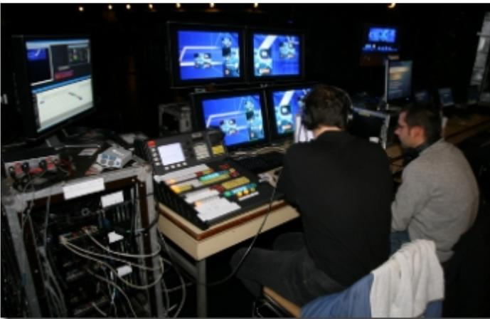
En gros, Encore sert à positionner les différentes sources vidéo sur l'image au grand format, à mémoriser des configurations (correspondant aux boutons sur l'écran ci-dessous), et ensuite à séparer la grande image en deux images avec un fondu entre les deux. Les deux images séparées sont envoyées aux deux projecteurs Christie.
