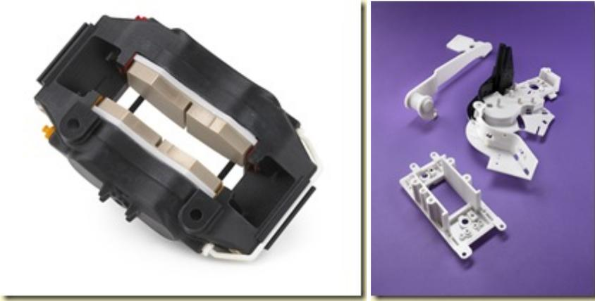
Il existe aussi des techniques de stéréolithographie (SLA) comme chez **3D Systems** qui utilise un laser, dans l'ultra-violet, pour polymériser un plastique liquide, couche par couche. Là encore, cela permet de produire des pièces de série en quantité moyenne. Sachant qu'il est aussi possible comme pour les machines de Z Corp de produire plusieurs pièces d'un coup.
