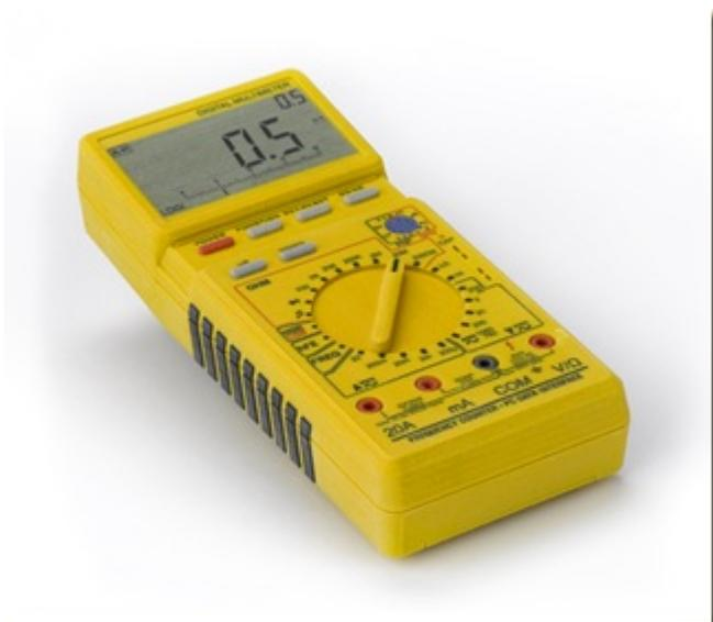
Voici un autre exemple, sachant qu'il n'a pas été imprimé avec chaque pièce détachée à part, mais – si j'ai bien compris – directement monté, la résolution étant suffisante pour bien séparer les pièces mécaniques de cet assemblage qui est donc fonctionnel et dont on pourra tester la cinématique complète. On peut aussi imprimer des coupes explicatives du fonctionnement interne d'objets complexes.
