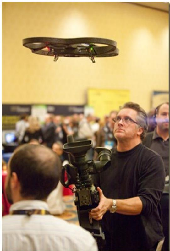
Les batteries sont remplaçables et ont une autonomie de 15 mn. Elles sont au Lithium et se chargent en 90 mn.
