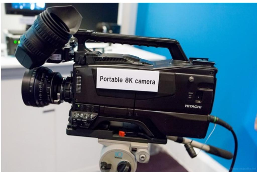
On y trouvait les différentes technologies de captation 8K et notamment de nouvelles caméras 4K plus légères : une caméra d'épaule dite "portable" (*ci-dessus*), d'origine **Hitachi** et une autre, encore plus petit provenant d'**Astro** (*ci-dessous*) mais qui n'est pas dotée d'un enregistreur. Ce qui prend de la place, c'est l'électronique d'accompagnement et le système d'enregistrement, qui doit gérer des débits énormes en RAW.
