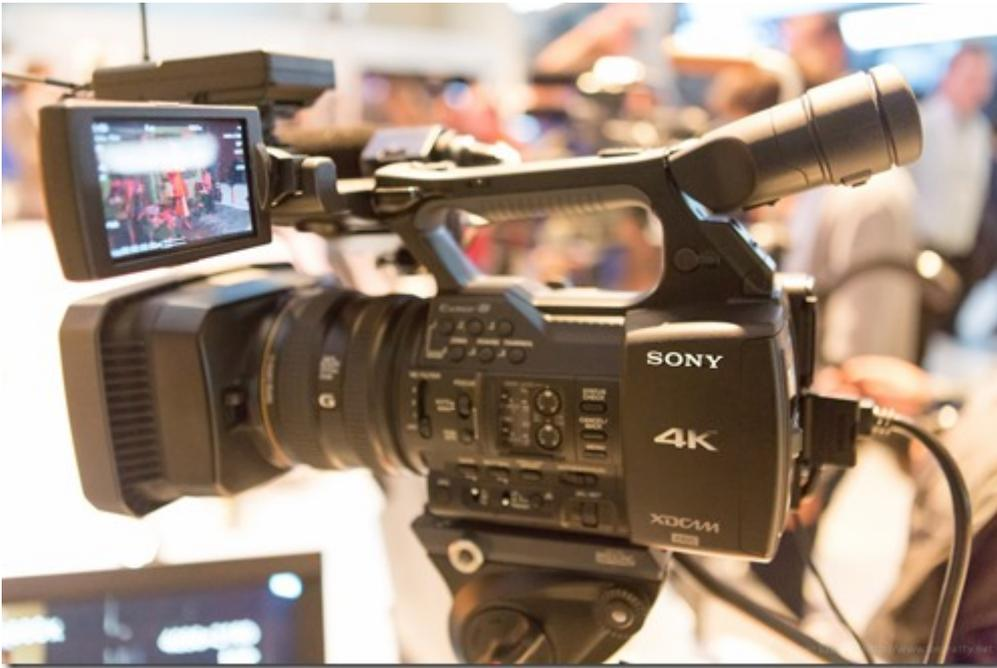
La FDR-AX1 et la PXW-Z100 sont dotées d'un capteur de petite taille : un 1/2,3 pouces, c'est-à-dire, celui d'un appareil compact d'entrée de gamme. Mais avec moins de photosites, 8 millions, que nombre d'appareils photos avec un capteur de ce format. Résultat : une bonne sensibilité pour la prise de vues en basse lumière. Les deux caméras ont un boîtier équivalent mais se distinguent sur les formats d'enregistrement vidéo.
