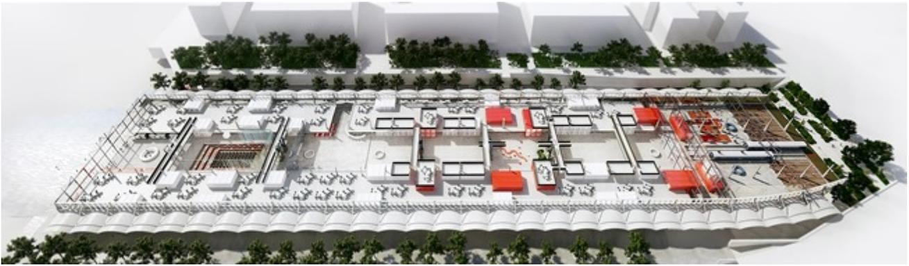
Les startups seront logées au milieu du bâtiment. Pour ne pas toucher aux poutrelles et au bâtiment, elles seront hébergées dans des locaux bâtis avec des blocs préfabriqués, sortes de containers empilés les uns sur les autres avec, selon la maquette, deux niveaux superposés. Un troisième niveau ouvert est constitué de zones de détente et de rencontres. Ci-dessous un close-up de la maquette.
