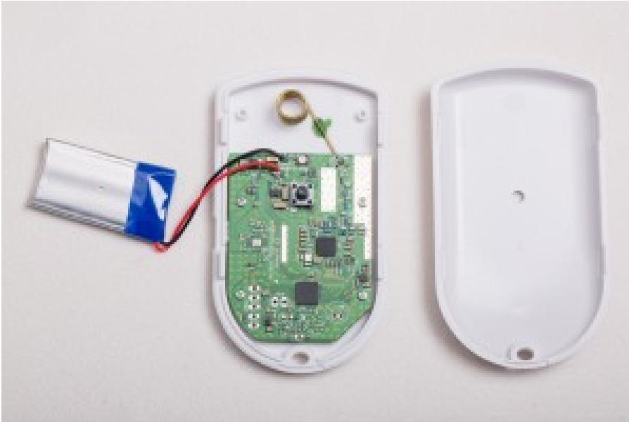
Le boîtier connecté Sens'It créé par Axible (Toulouse) et distribué aux participants de la conférence OVHSummit, doté d'un capteur de température et de mouvements et relié aux data-centers d'OVH via le réseau M2M de Sigfox.
