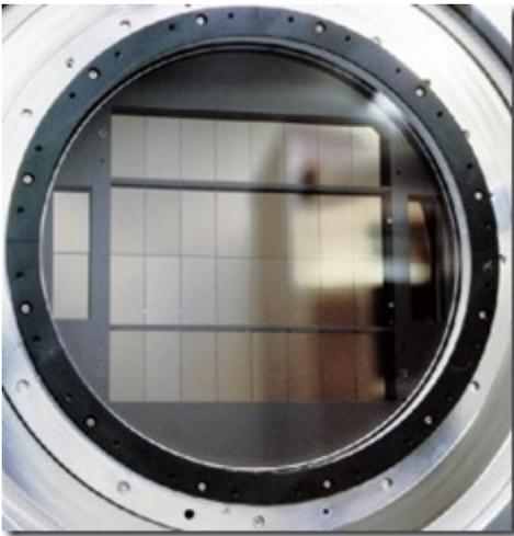
A noter cette **intéressante vidéo** qui décrit le processus de maintenance du miroir principal des VLT. Un bâtiment lui est dédié qui le nettoie, enlève la couche existante d'aluminium puis en remet une par déposition sous vide, et elle ne pèse que 12 grammes au total !
