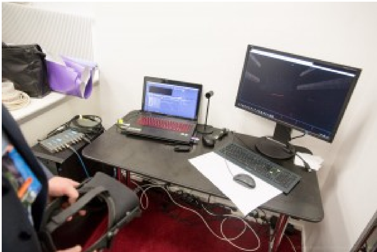
Le poste de travail de simulation 3D de la salle Pleyel, associé à un casque Oculus Rift pour visualiser la salle et les effets de lumière intégrant les panneaux d'Ayrton.
