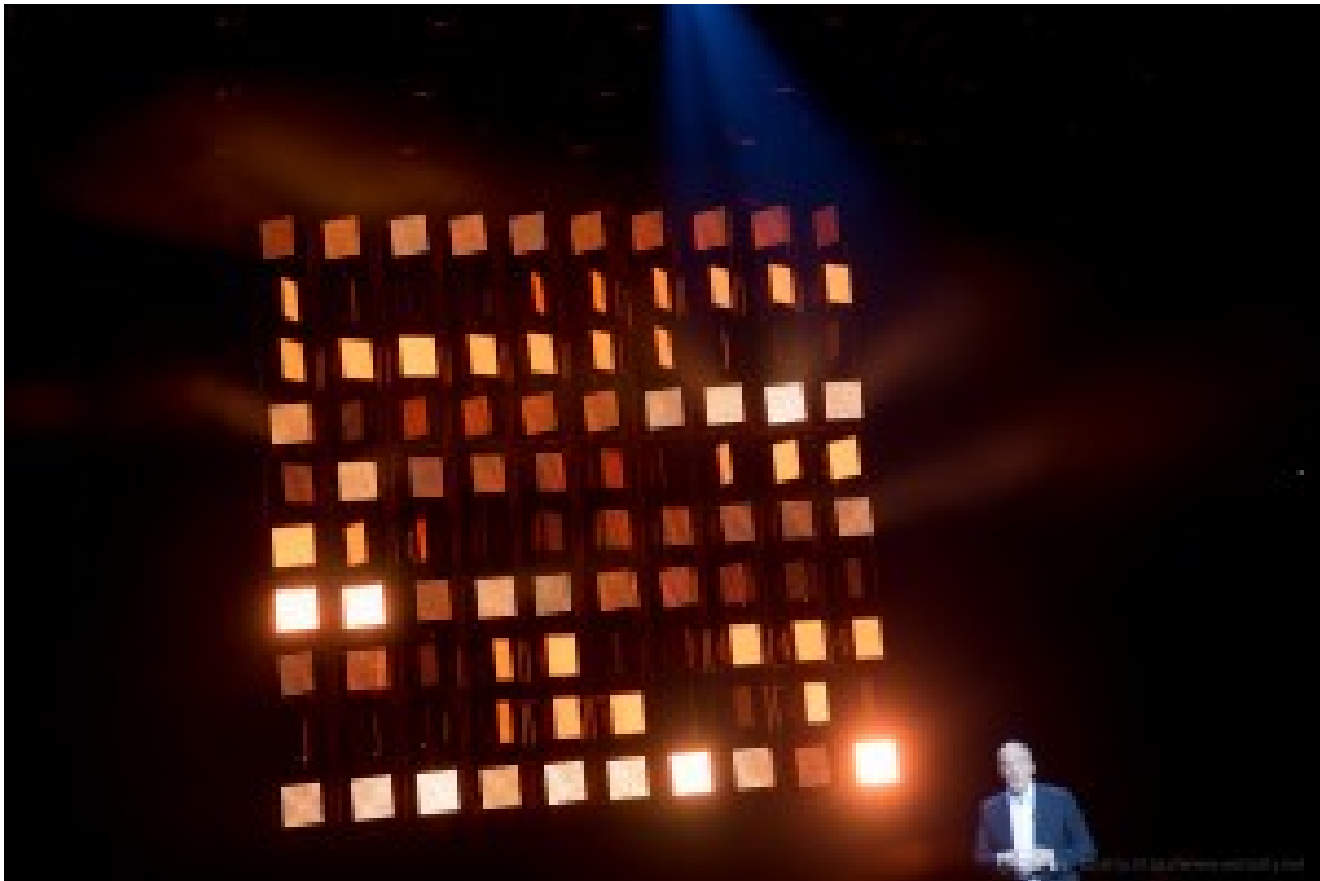
Les Dreampanel Twin ont un côté pile avec de grosses LED et un côté face avec de petites LED. Ces panneaux bifaces sont motorisés sur deux axes. Ingénieurs !
