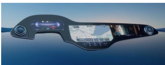
Mercedes MBUX Hyperscreen écran OLED ultrawide de 56 pouces qui rappelle celui des Byton
