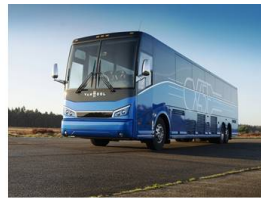
bus électrique Van Hool CX45E (Belgique) avec 500 km d'autonomie théorique
