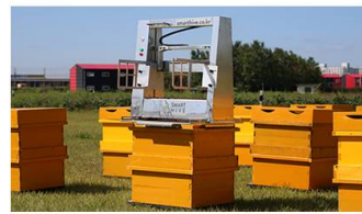
Daesung Hive Controller : robotisation du nettoyage des ruches
